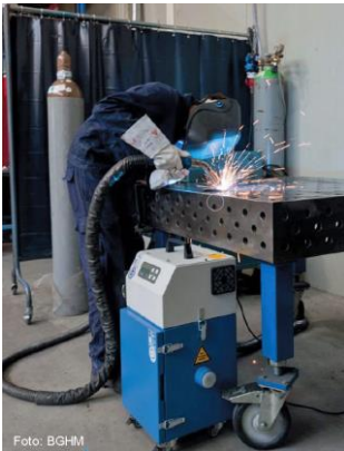
„Brennerintegrierte Absaugung“ mit mobiler HV Absaugung
