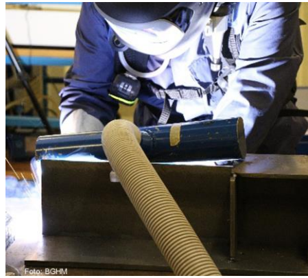
„Punktabsaugung“ mit HV Absaugung
